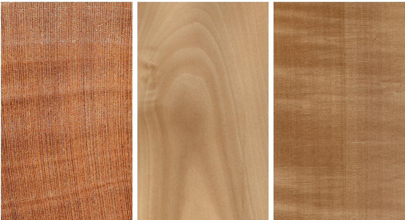
Elsbeere ( Torminalis glaberrima ): Querschnitt (ca. 10x), tangentielle und radiale Oberfläche (natürliche Größe)
