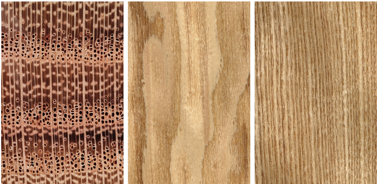
Gleditschie ( Gleditsia triacanthos ): Querschnitt (ca. 10x); tangentielle und radiale Oberfläche (natürliche Größe)
