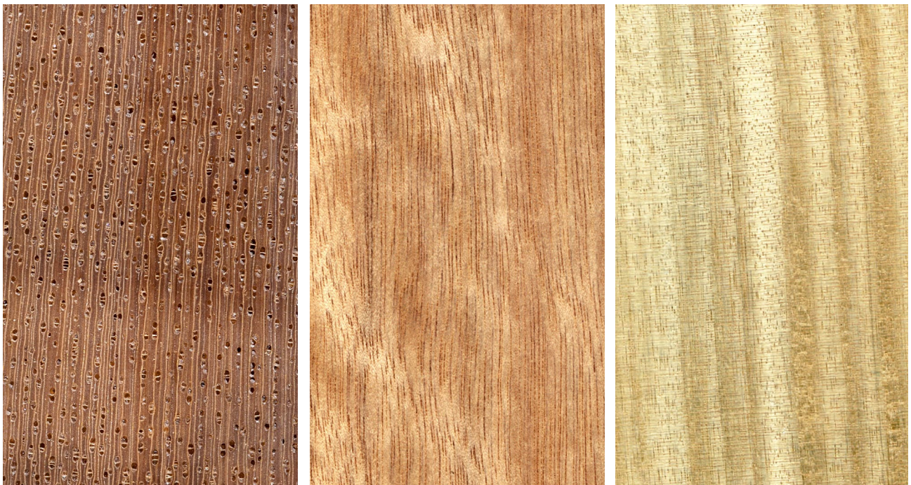
Kedondong ( Canarium spp.): Querschnitt (ca. 12x), tangentiale und radiale Oberfläche (natürliche Größe)
