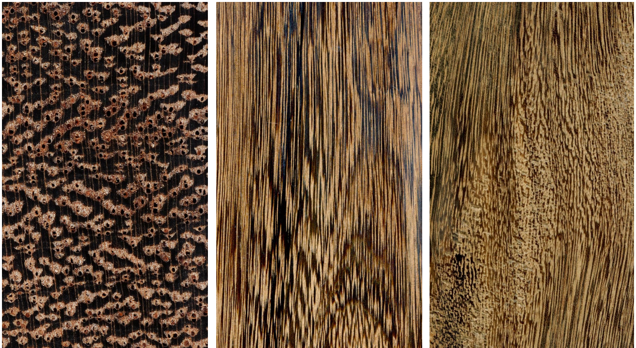
Wacapou ( Vouacapoua americana ): Querschnitt ca. 10x, tangentielle und radiale Oberfläche (natürliche Größe)
