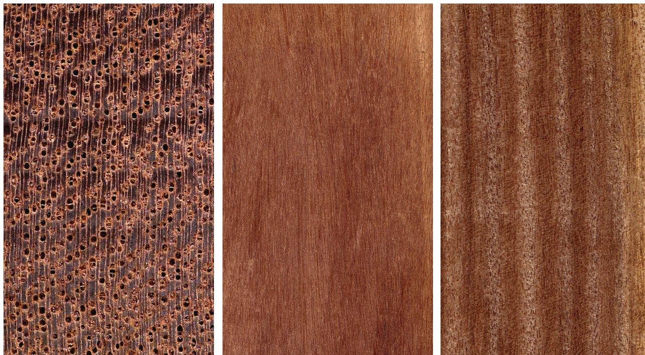
Louro vermelho ( Sextonia rubra ): Querschnitt (ca. 10x), tangentiale und radiale Oberfläche (natürliche Größe)
