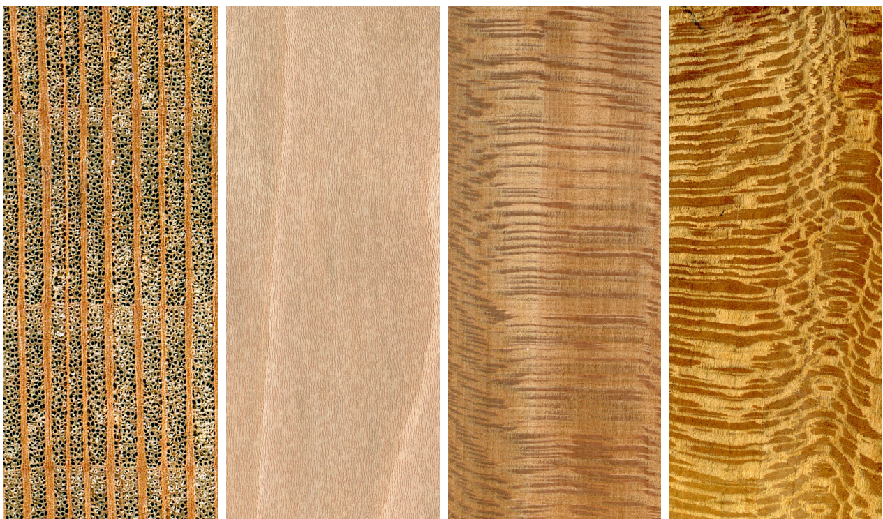
Platane ( Platanus occidentalis ): Querschnitt 10x, tangentiale und radiale Oberfläche; ganz rechts radiale Oberfläche von P. orientalis gedämpft (natürliche Größe)
