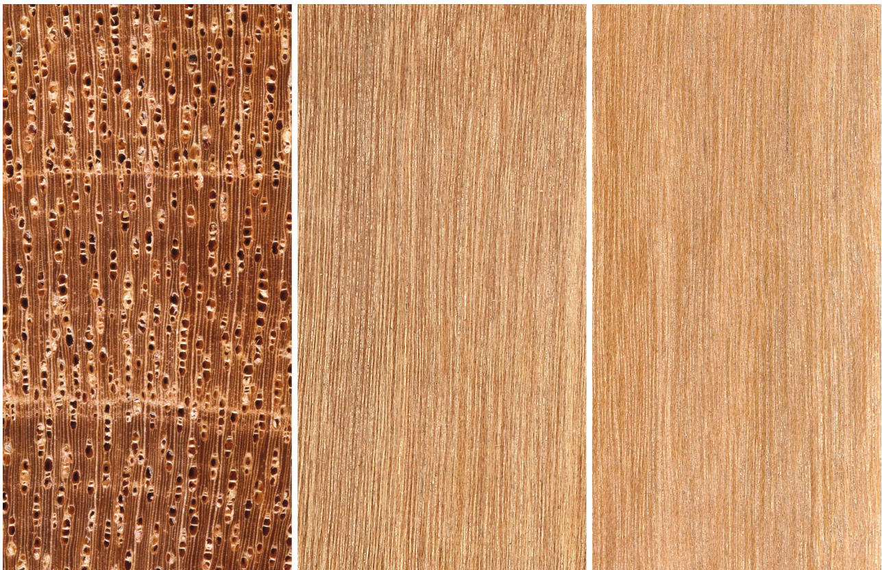
Punah ( Tetramerista glabra ): Querschnitt (ca. 12x), tangentiale und radiale Oberfläche (natürliche Größe)
