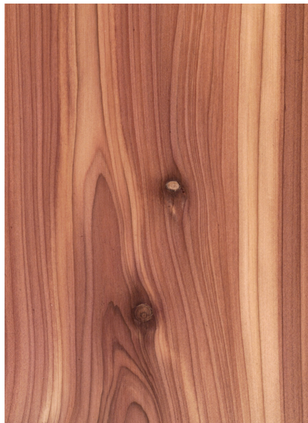
Eastern redcedar ( Juniperus virginiana ): Querschnitt (ca. 12x) und tangentialer Oberfläche (natürliche Größe)
