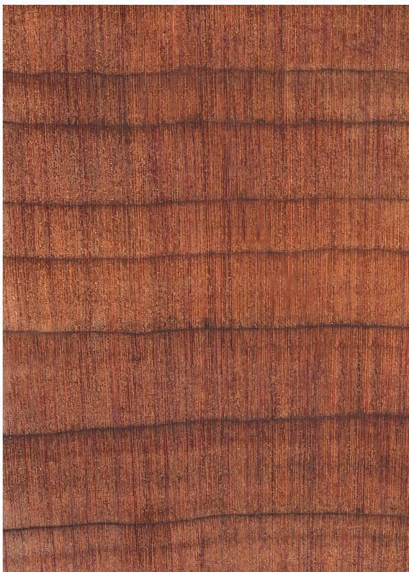
Eastern redcedar ( Juniperus virginiana ): Querschnitt (ca. 12x) und tangentialer Oberfläche (natürliche Größe)
