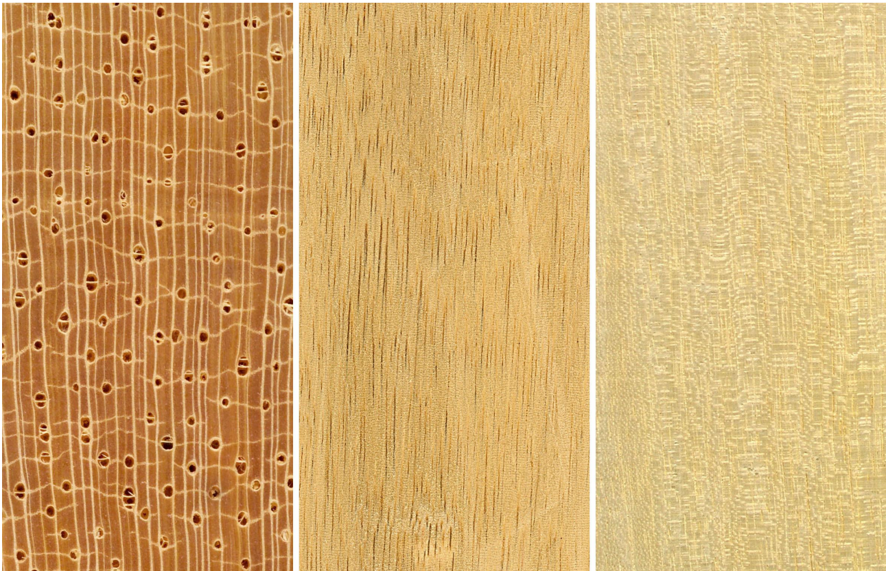
Marupá ( Simarouba amara ): Querschnitt (ca. 12x), tangentiale und radiale Oberfläche (natürliche Größe)
