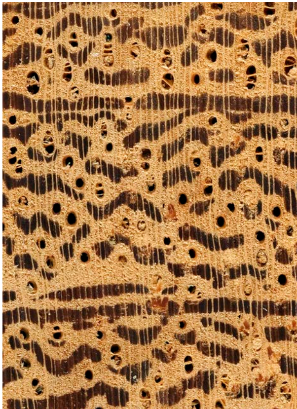
Andira ( Andira spp.): Querschnitt (ca. 12x) und tangentialer Oberfläche (natürliche Größe)
