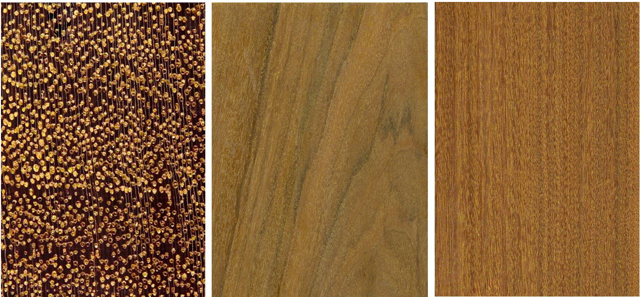
Ipé ( Handroanthus spp.): Querschnitt (ca. 10-fach), tangentielle und radiale Oberfläche (natürliche Größe)
