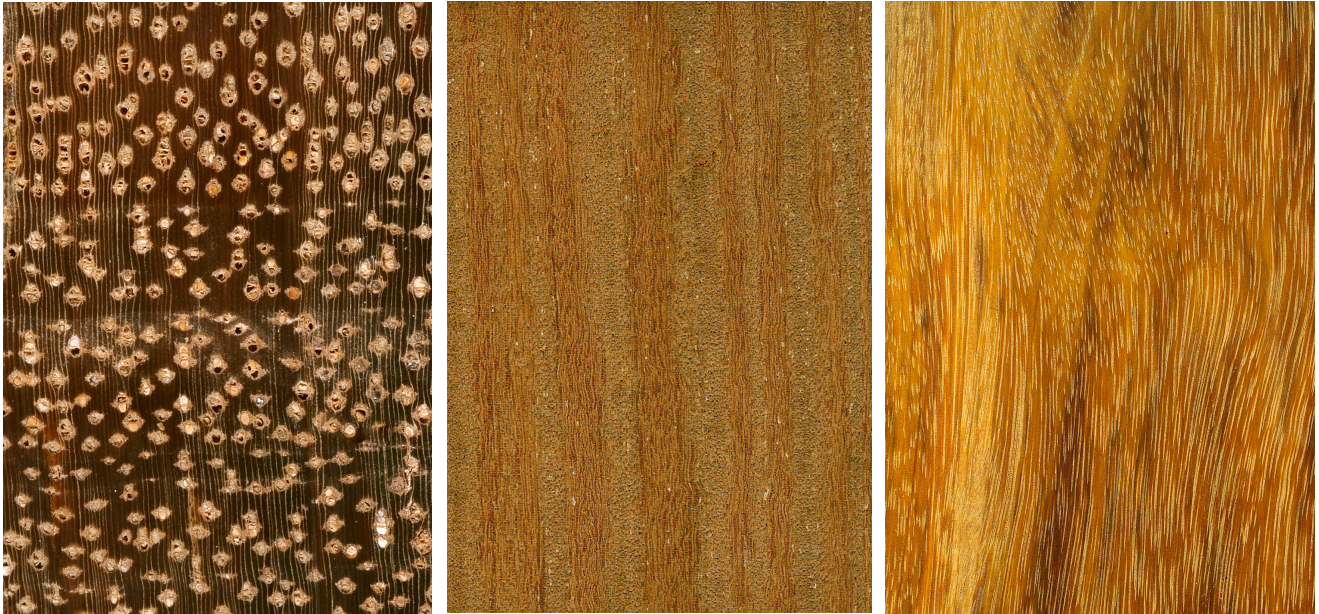
Cumarú ( Dipteryx odorata ): Querschnitt ca. 10x; tangentielle und radiale Oberfläche (natürl. Größe)
