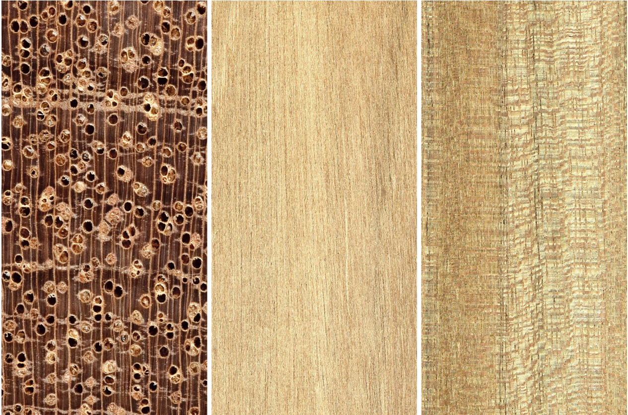
White Seraya ( Parashorea spp.): Querschnitt (ca. 12x), tangentielle und radiale Oberfläche (nat. Größe)
