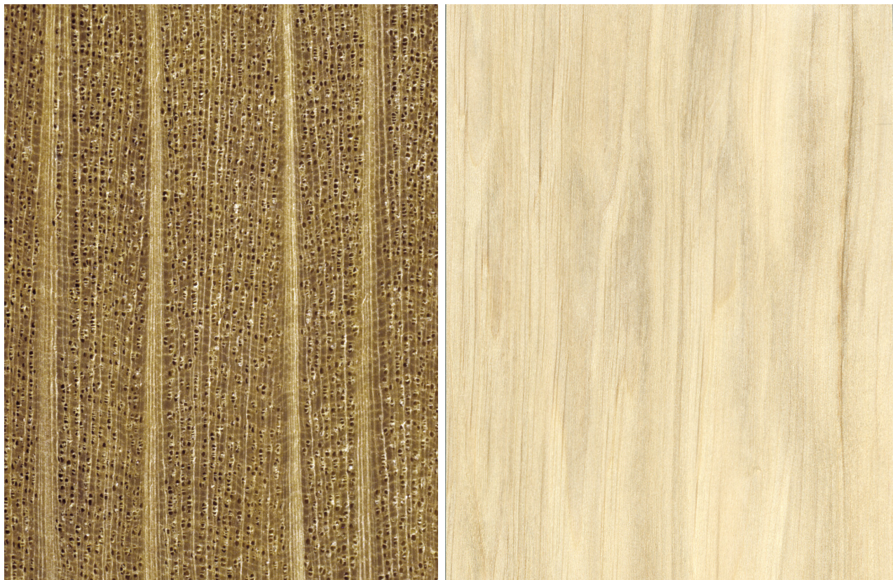
Hainbuche ( Carpinus betulus ): Querschnitt (ca. 12x), tangentiale Oberfläche (natürliche Größe)
