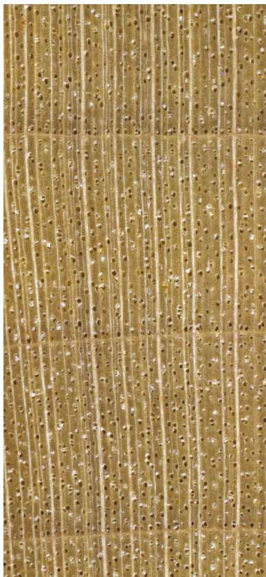
Ahorn, ( Acer spp.): Querschnitt (ca. 12x), tan. Oberfläche (natürliche Größe) und Vogelaugenahorn
