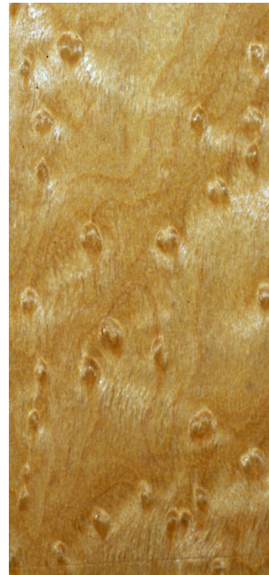
Ahorn, ( Acer spp.): Querschnitt (ca. 12x), tan. Oberfläche (natürliche Größe) und Vogelaugenahorn
