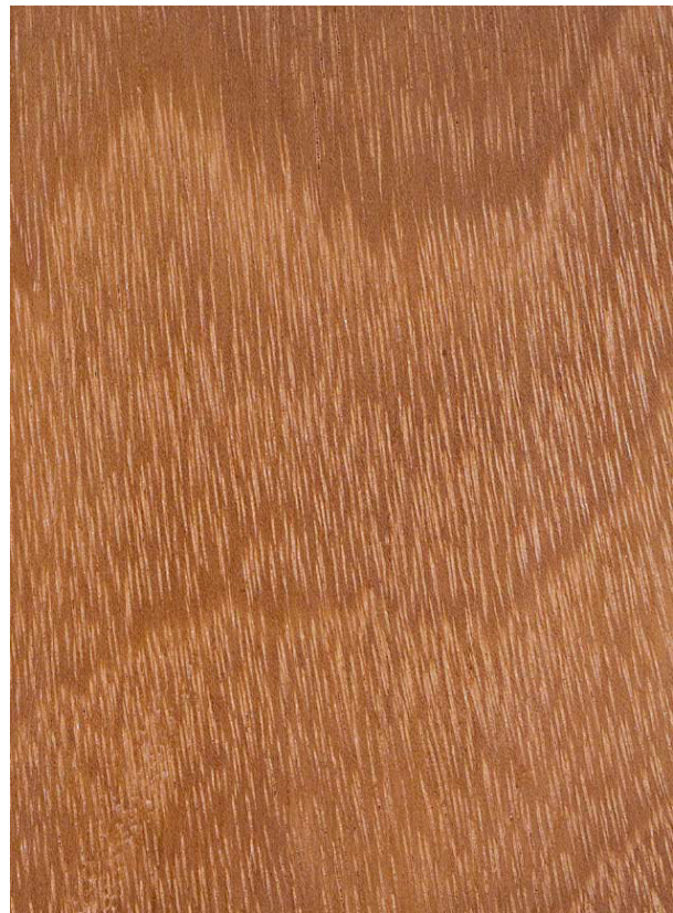
Tatajuba ( Bagassa guianensis ): Querschnitt (ca. 12x) und tangentiale Oberfläche (natürliche Größe)
