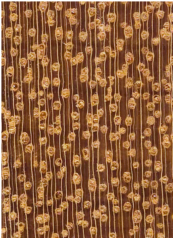
Tatajuba ( Bagassa guianensis ): Querschnitt (ca. 12x) und tangentiale Oberfläche (natürliche Größe)
