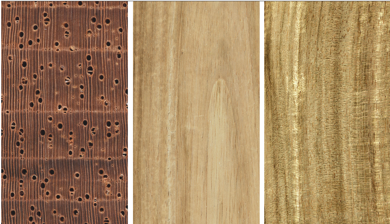
Faro ( Daniellia ogea ): Querschnitt ca. 10x, tagentiale und radiale Oberfläche (natürliche Größe)
