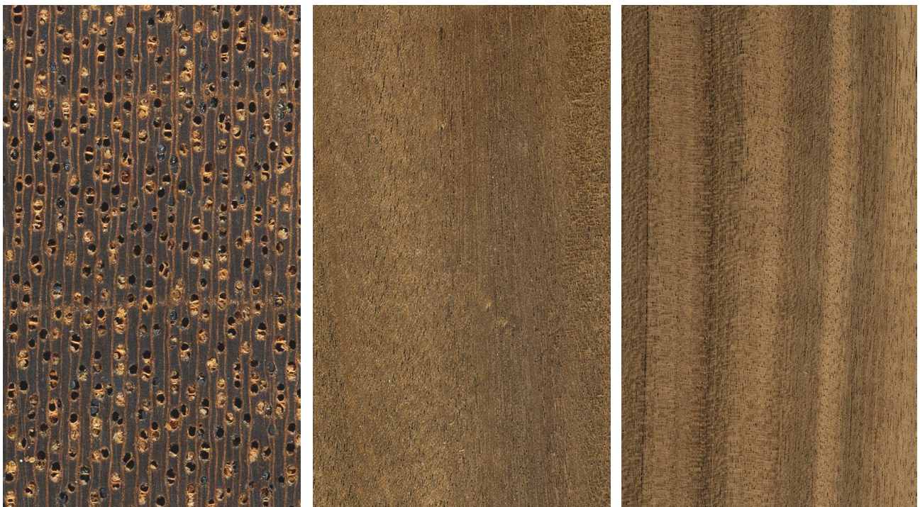
Dibétou ( Lovoa trichilioides ): Querschnitt (ca. 10-x), tangentielle und radiale Oberfläche (natürliche Größe)
