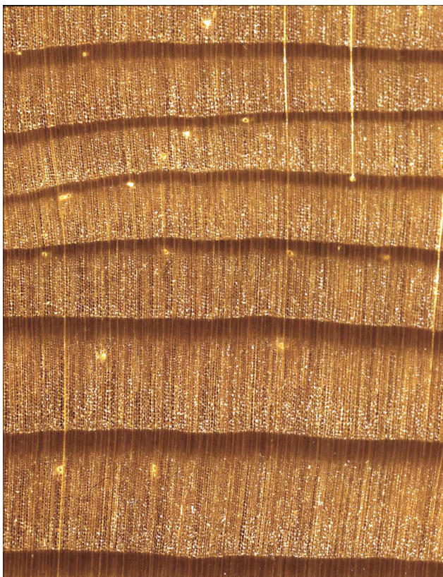
Lärche ( Larix spp.): Querschnitt (ca. 12x) und radiale Oberfläche (natürliche
