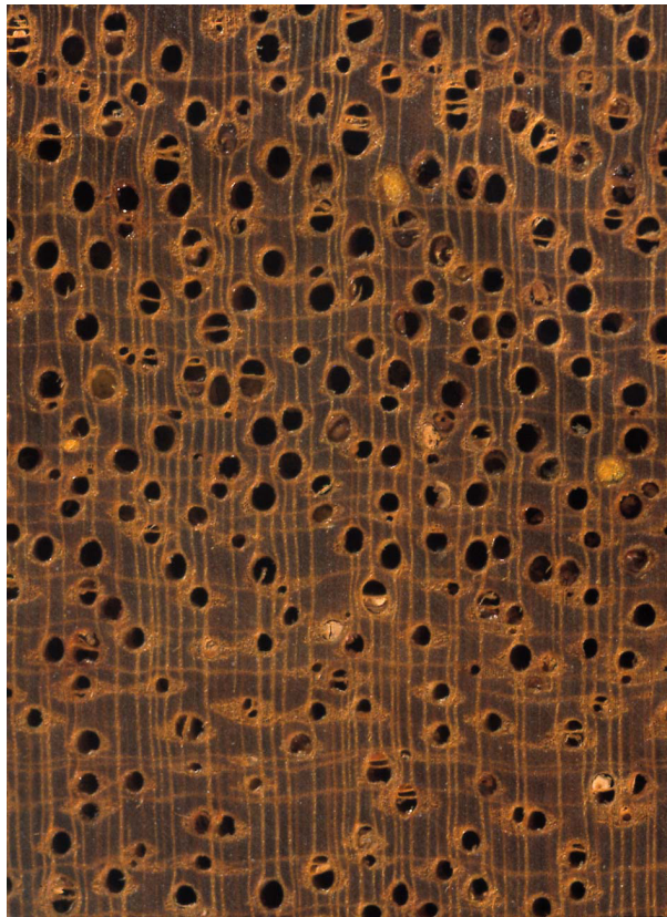
Merbau ( Intsia spp.): Querschnitt (ca. 12x) und radiale Oberfläche (natürliche
