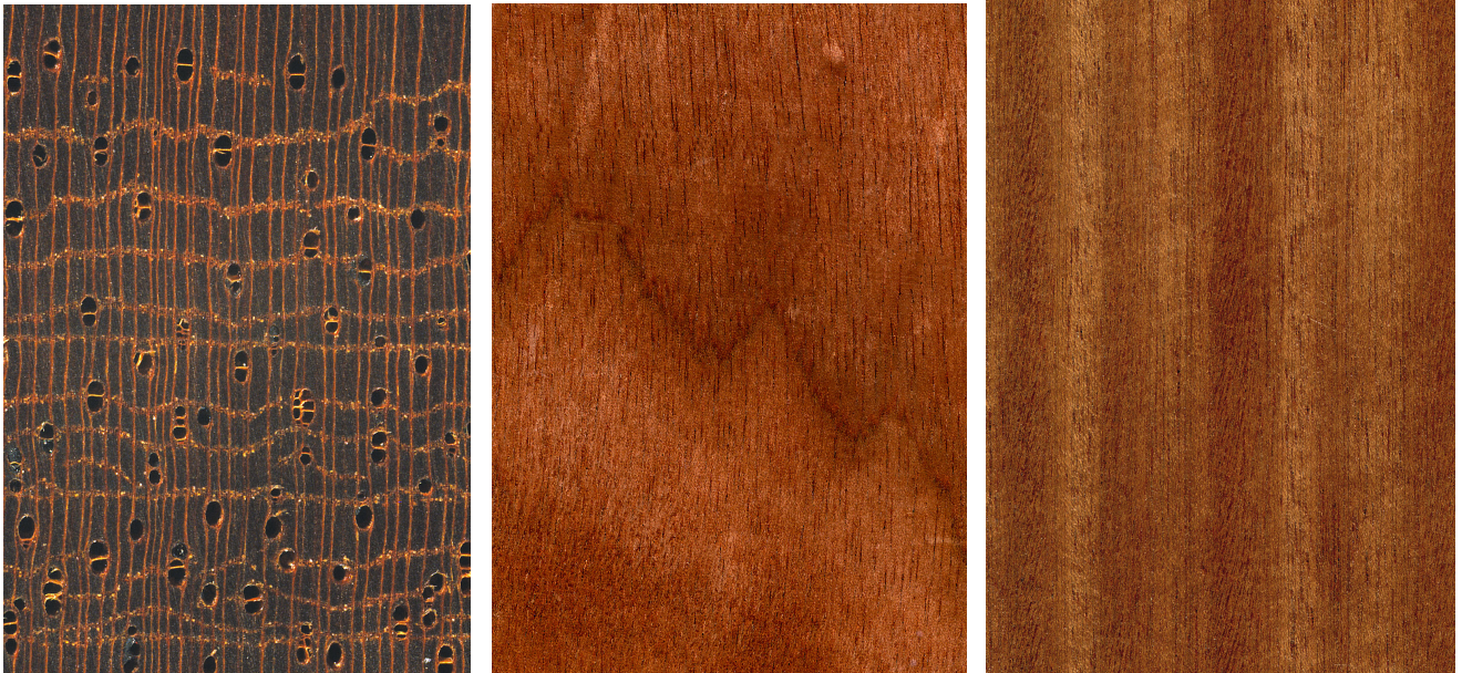
Sipo ( Entandrophragma utile ): Querschnitt (ca. 10x), tangentielle und radiale Oberfläche (natürliche Größe)
