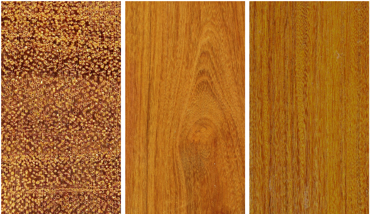
Fernambuk ( Paubrasilia echinata ): Querschnitt (ca. 10x); tangentielle und radiale Oberfläche (natürliche Größe)
