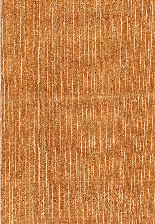
Buchsbaum ( Buxus sempervirens ): Querschnitt ca. 10x, tangentiale Oberfläche (natürliche Größe)
