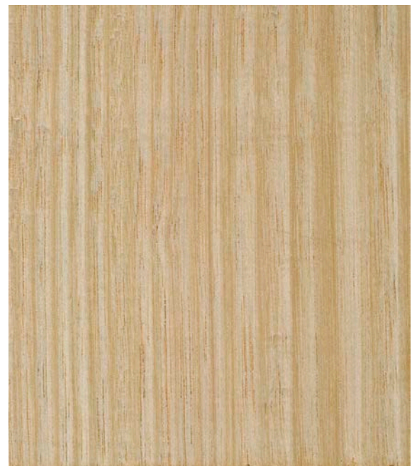
Tasmanien Oak, ( Eucalyptus spp.): Querschnitt (ca. 12x) und tan. Oberfläche (natürliche Größe)
