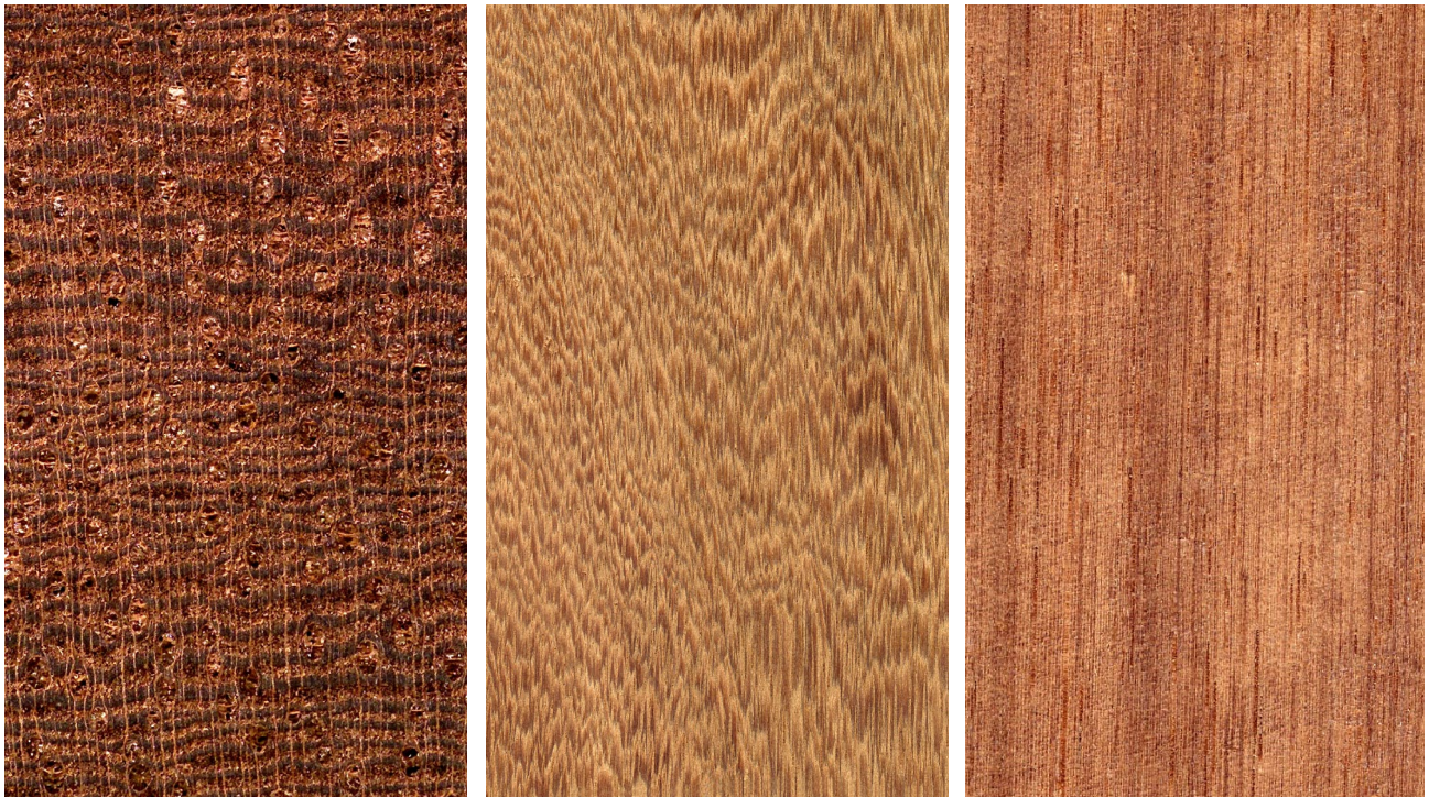
Cambará ( Erisma uncinnatum ): Querschnitt ca. 10x, tangentiale und radiale Oberfläche (natürliche Größe)
