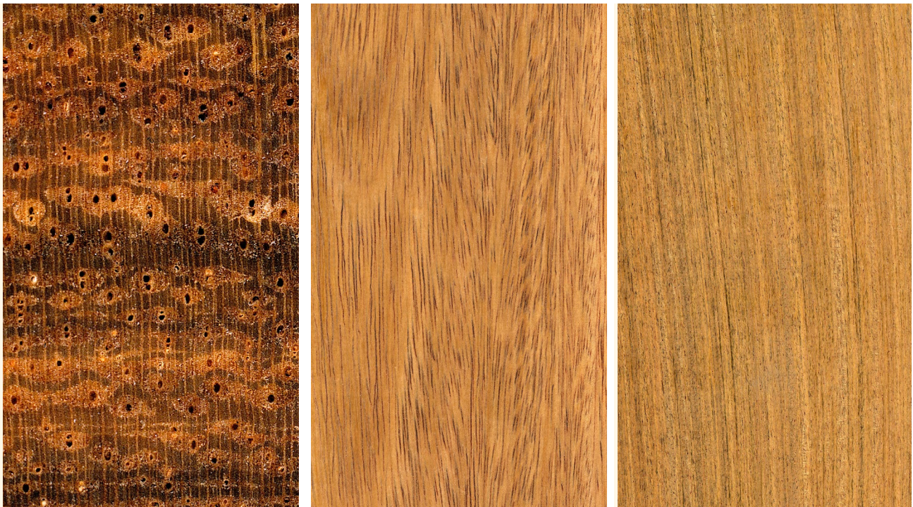
Cerejeira ( Amburana spp.) Querschnitt (ca. 10x), tangentielle und radiale Oberfläche (natürliche Größe)
