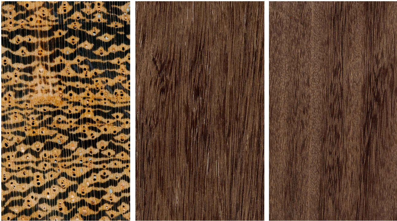
Sucupira: Querschnitt ca. 10x ( Bowdichia nitida ); tangentiale und radiale Oberfläche, natürliche Größe ( Diploptropis purpurea )
