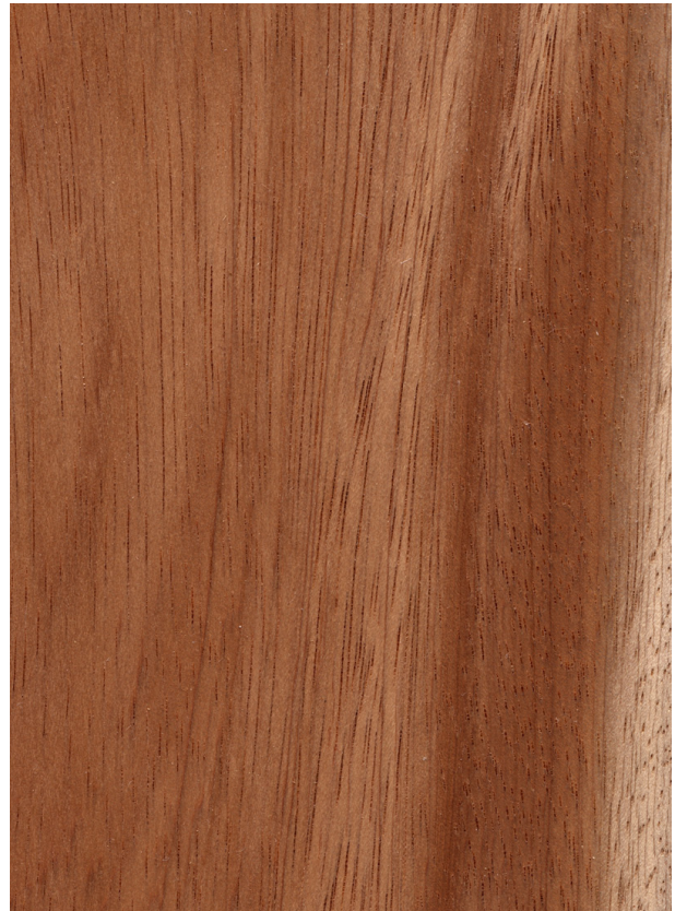
Bintangor ( Calophyllum spp.): Querschnitt (ca. 12x) und tangentielle Oberfläche (natürliche Größe)
