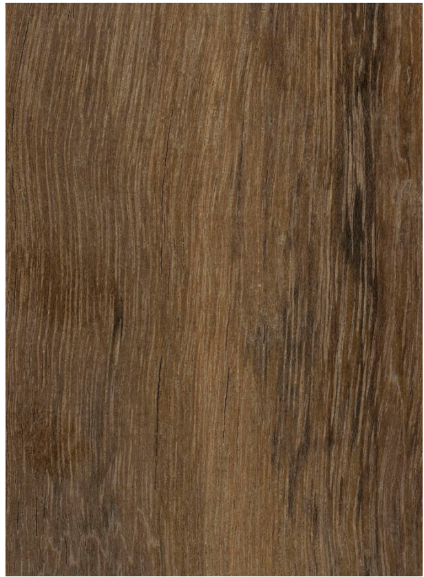
Ovengkol ( Guibourtia ehie ): Querschnitt (ca. 12x) und tangentiale Oberfläche (natürliche Größe)
