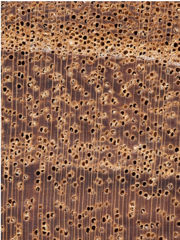
Weißes Meranti ( Shorea sp.): Querschnitt (ca. 12x) und radiale Oberfläche (natürliche Größe)
