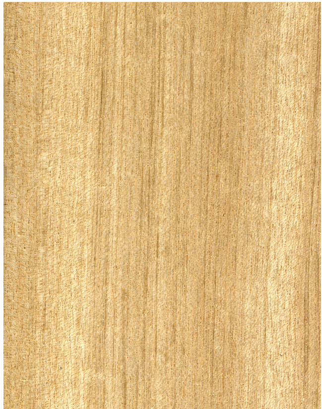
Weißes Meranti ( Shorea sp.): Querschnitt (ca. 12x) und radiale Oberfläche (natürliche Größe)
