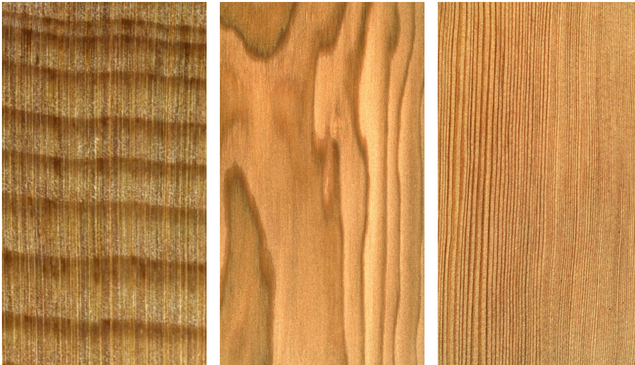
Hemlock ( Tsuga heterophylla ): Querschnitt (ca. 12x), tangentielle und radiale Oberfläche (natürliche Größe)
