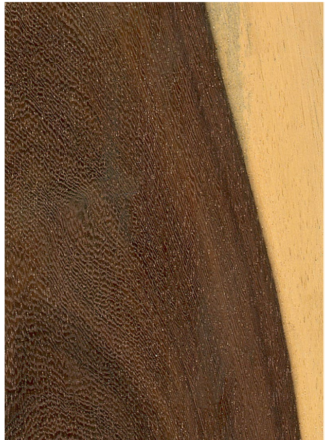
Katalox ( Swartzia cubensis ): Querschnitt (ca. 12x) und tangentiale Oberfläche (natürliche Größe)
